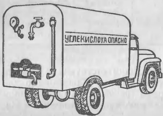
Рис. 47. Общий вид газификатора (танка) низкого давления при безбаллонном снабжении \text{CO}_2
